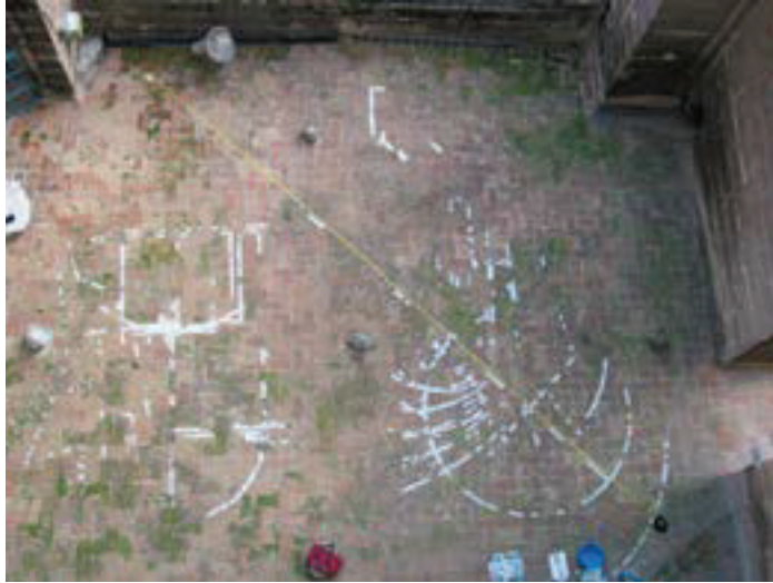
Figura 4.- Montea renacentista de bóveda semiesférica
